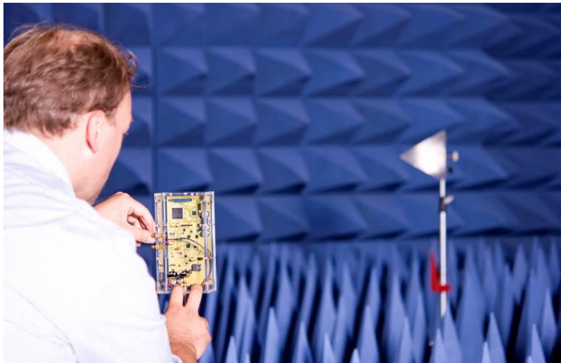
Das Radarsystem in der Messkammer: Die Hardware entstand an der RUB, die Algorithmik am KIT. (Foto: Timo Jaeschke, RUB)
