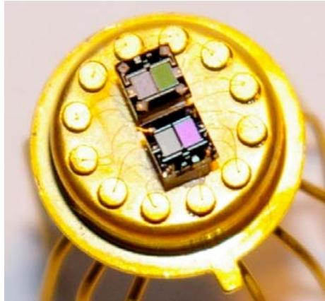
Bildunterschrift: Am Fraunhofer IPM entwickeltes und hergestelltes Gassensorarray mit vier Wirkschichten:  $\text{SnO}_2$ ,  $\text{SnO}_2/\text{Pt}$ ,  $\text{WO}_3$  und CTO. Die Abmaße des Sensorarrays betragen  $(1,5 \times 1,5) \text{ mm}^2$ . (© Fraunhofer IPM)
