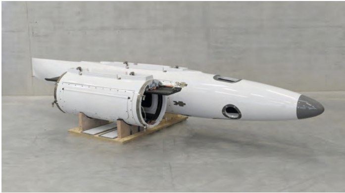
Hier ist CFK bereits im Einsatz: Instrumententräger und vollständiger Unterflügelbehälter für das Forschungsflugzeug HALO, entwickelt und hergestellt von der Fa. Aerostruktur
