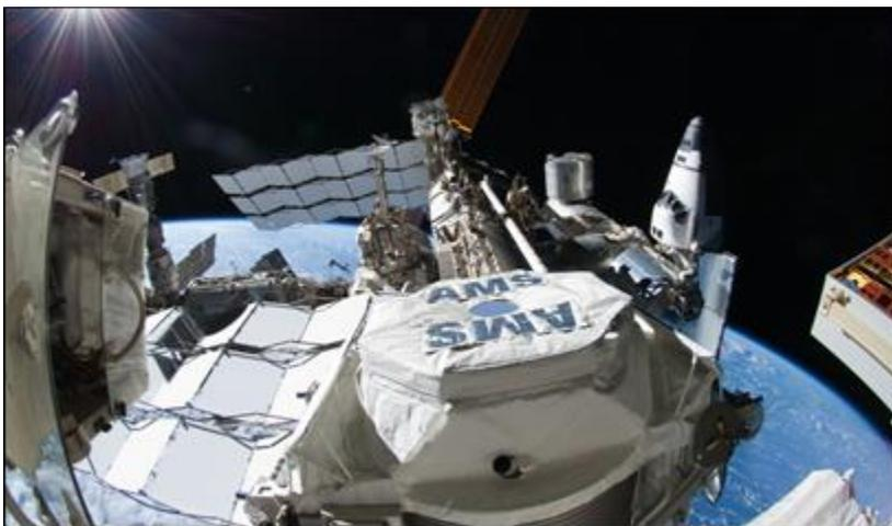
Der Detektor AMS (Alpha-Magnet-Spektrometer) auf der Internationalen Raumstation ISS. Mit diesem Teilchendetektor erforschen Wissenschaftler Ursprung und Natur der kosmischen Strahlung. (Foto: NASA)
