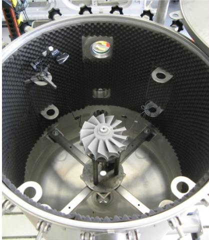
BTU-Versuchsanlage: Geöffneter Druckbehälter mit Laufwerk, Quelle: MTU Friedrichshafen
