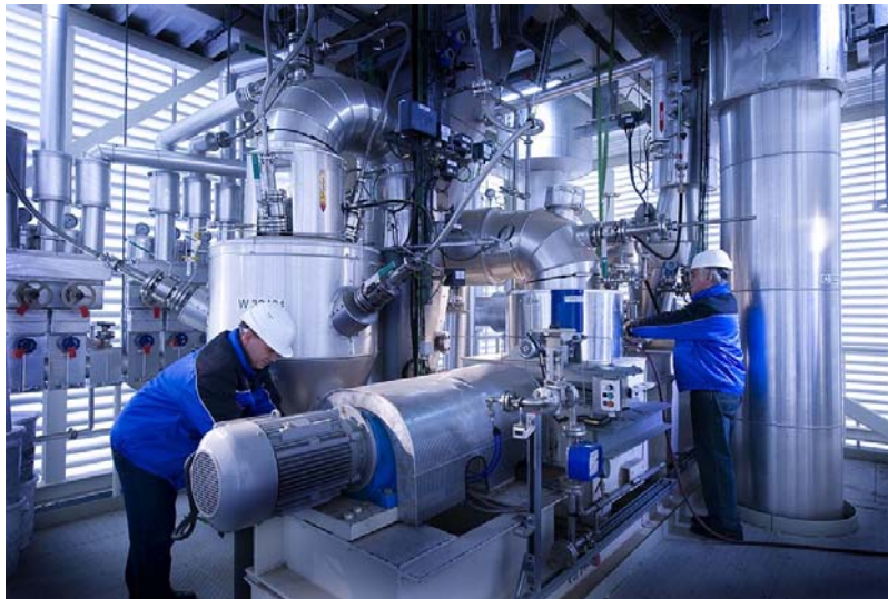
Der Reaktor zur Herstellung von bioliqSynCrude ® am KIT-Campus Nord - die erste Stufe im bioliq ® -Verfahren. (Foto: Markus Breig)
