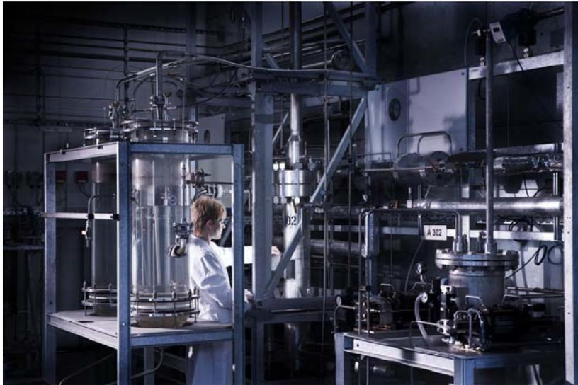
*Das Innere der VERENA-Anlage am KIT-Campus Nord. In dieser Versuchsanlage entsteht Wasserstoff aus nasser Biomasse. (Foto: Markus Breig)*
