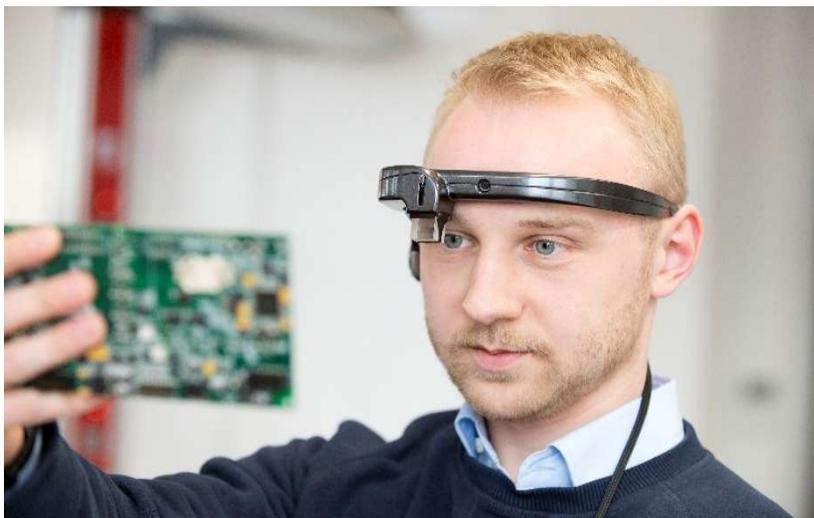
*Mithilfe einer Augmented Reality-Brille versteht der digitale Assistent, was der Träger sieht. So können Maschine und Mensch in Echtzeit kommunizieren. (Foto: Tanja Meißner, KIT)*
