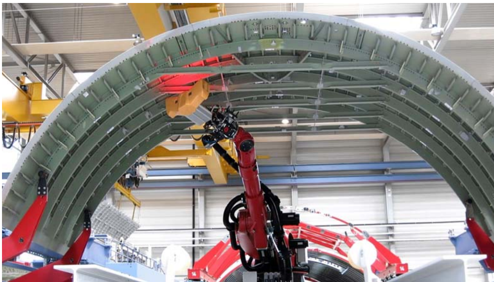
Prüfroboter bei der Vollständigkeitsprüfung einer Flugzeugumpfschale. Foto: Fraunhofer IFF
