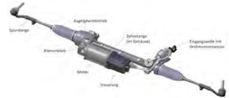
Elektromagnetisches Lenkgetriebe 1er/3er BMW (Baureihe F20/F30)
