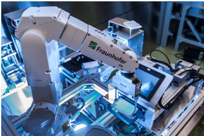
**Automatisiertes Beladen des I-DOTs. Die einfache Einbindung in komplexe biologische Prozesse wird durch standardisierte Geräteschnittstellen ermöglicht.**
