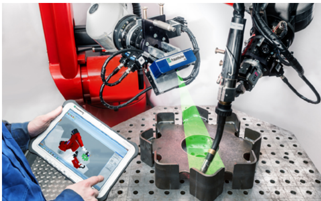
Schweißen für Losgröße 1: Die Werkstückerkennung und Programmgenerierung erfolgt weitgehend automatisch und der Werker kann über ein Tablet Anpassungen vornehmen. (Quelle: Fraunhofer IPA/Foto: Rainer Bez)
