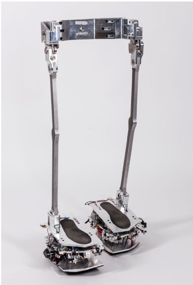
Bei »Servus RGS Adapt« haben die IPA-Wissenschaftler das bestehende System ohne Knieeinheit um Sensoren, Aktoren und eine dritte Bodenplatte erweitert. (Quelle: Fraunhofer IPA, Foto: Rainer Bez)
