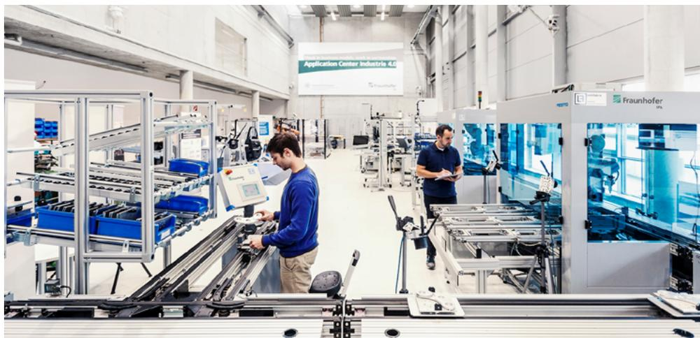
Bei der »Smarten Systemoptimierung« zeichnen Kameras die relevanten Prozessmerkmale in verketteten Anlagen auf. Auf dieser Basis ermittelt die Anwendung die wichtigsten Fehlerquellen und deren Ursachen. (Quelle: Universität Stuttgart IFF/Fraunhofer IPA, Foto: Rainer Bez)
