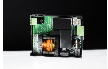
Weniger Wartungsaufwand bei Elektrogeräten bringt das am KIT entwickelte Netzteil. (Foto: Markus Breig, KIT)
