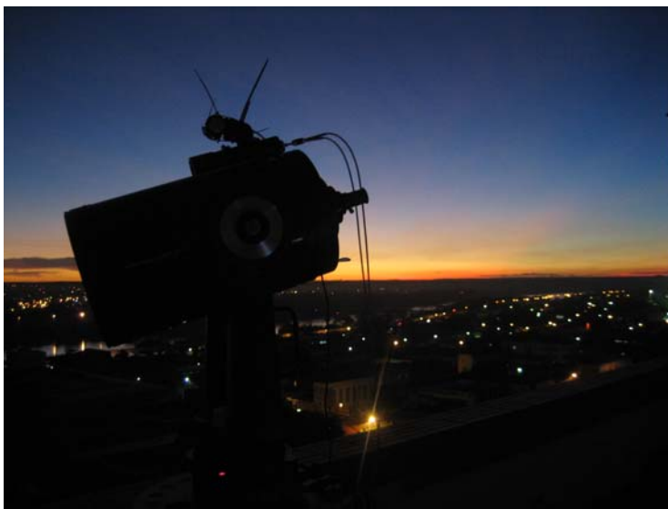
Teleskop für ein bodengestütztes Spektrometer. Ziel ist die Fernerkundung von Treibhausgasen (Foto: Sebastian Kreyco)
