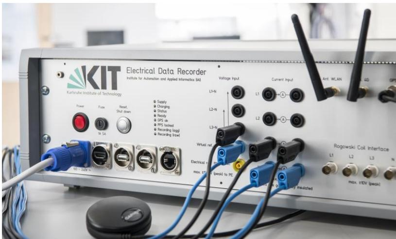
Der am KIT entwickelte Datenrekorder verwendet einen GPS-Empfänger und zeichnet Roh- und Frequenzdaten mit sehr hoher Auflösung auf. (Foto: Amadeus Bramsiepe, KIT)
