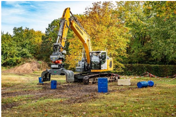
Abb. 1 Der autonome Bagger ALICE beim Bergen von Fässern. Hier handelt es sich um eine frühere Demo, bei der aus 50 m Entfernung gesteuert wurde.
