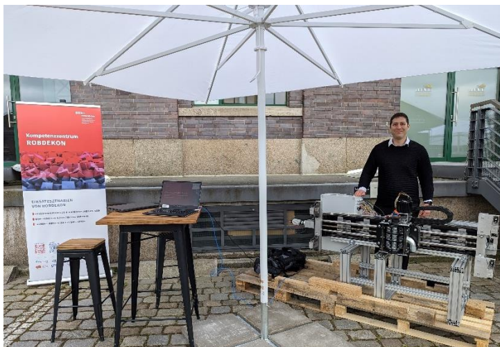
Abb. 3 Mit dieser Fräse des KIT-TMB können die Betonwände kerntechnischer Anlagen dekontaminiert werden.
