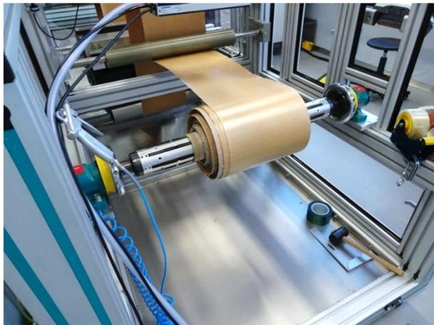
**Abb. 1** Papierbeschichtung auf der Rolle-zu-Rolle-Anlage.
