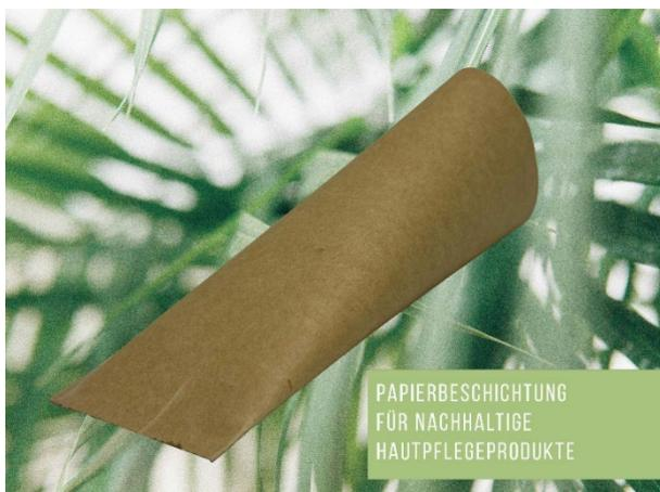
**Abb. 2** Beschichtetes Papier mit Barrierewirkung für die Herstellung von Kosmetiktuben. Hier wirkten neben dem Fraunhofer ISC die Projektpartner Polymaris, IPC und Albea mit
