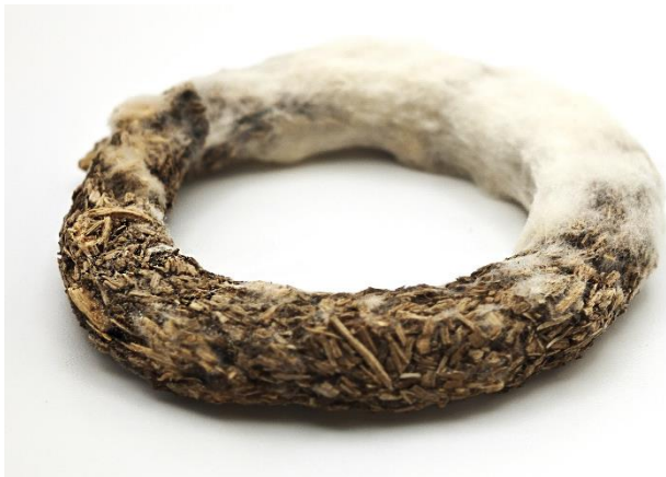
Abb. 2 Je nach Zusammensetzung des Substrats, Art des Pilzes und Wachstumsbedingungen können bei Pilzmyzelwerkstoffen verschiedene Eigenschaften während der Kultivierung gezielt eingestellt werden: beispielsweise harte und feste Strukturen © Fraunhofer IWU www.iwu.fraunhofer.de
