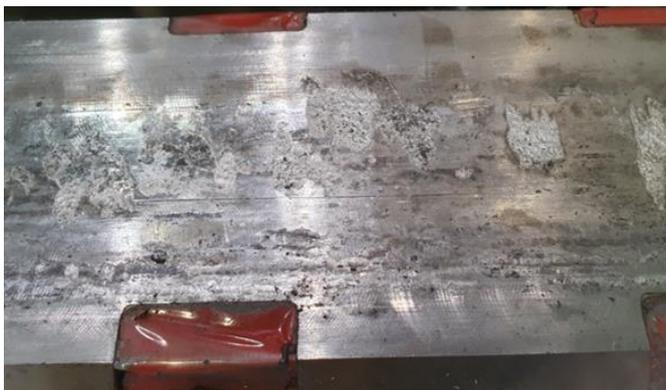
**Abb. 2 Spannprozess mit Schlagkeilen: Verschleißmarken am Gegenschlaghammer (Untergesenk) in den Bereichen der höchsten Belastung nach 15 Schmiedestücken**
