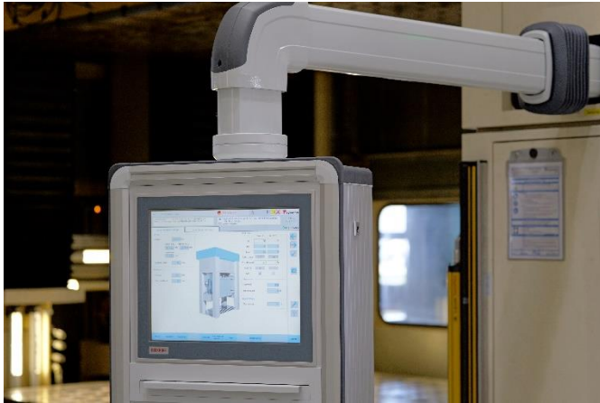
Abb. 2 Das neue, schwenkbare Bedienpanel ermöglicht, die komplexen Steuerungsfunktionen zentral und immer in der besten Bedienposition zu nutzen.
