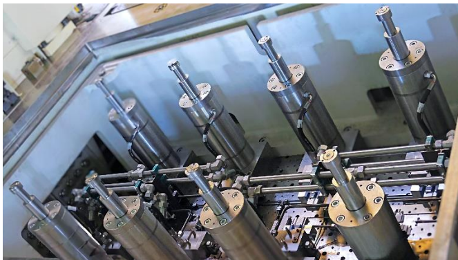
Abb. 1 Neues stationäres Ziehkissen mit acht Hydraulikzylindern: Es ist so ausgelegt, dass beim Werkzeugwechsel keine aufwendigen Umrüstungen an der Presse durchgeführt werden müssen. An der Auslegung des neuen Ziehkissens waren Experten des Fraunhofer IWU maßgeblich beteiligt.
