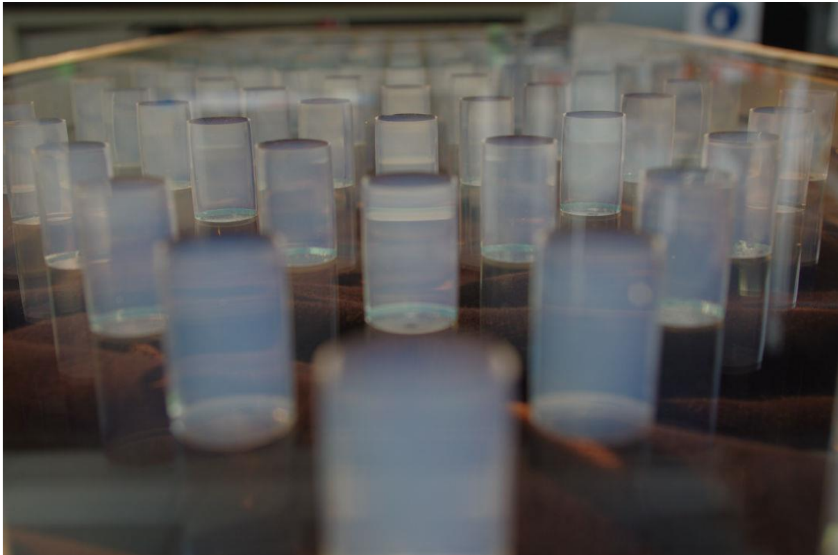
Abb. 1: Die zuverlässige Bestimmung thermischer und mechanischer Eigenschaften ist Voraussetzung für die anwendungsorientierte Materialentwicklung. Hier: mechanisch stabile Silica-Aerogele mit geringer Wärmeleitfähigkeit als Abstandshalter in Vakuumverglasungen. Foto: © CAE
