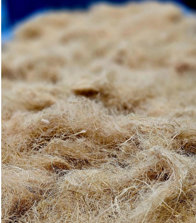
Abb. 1 Hanffasern statt Glasfasern: Biogene Reststoffe können in SMCs Kunstfasern ersetzen, deren Herstellungsprozess energieintensiv ist. Im Bild: Größere Hanffasern auf dem Förderband vor dem Aufschließen und Verbinden mit der Matrix.
