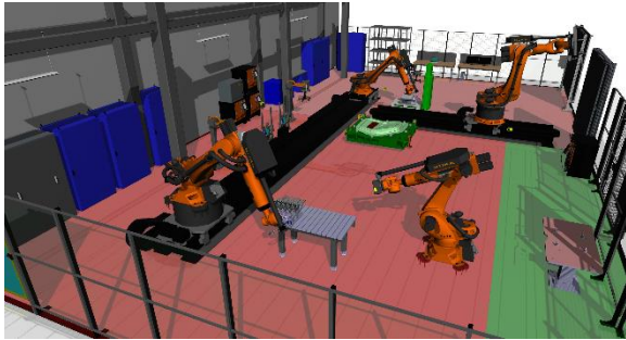
Abb. 1 Digitaler Zwilling der REAL-M: Im Beispielszenario sind Zerspanungs- und Umformprozesse umgesetzt, einschließlich der dazugehörigen Logistik © Fraunhofer IWU
