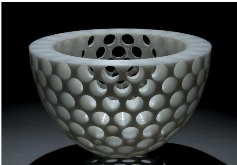
*Optimierte Halterung für die Ultraschall-Sensoren – die dann ein dreidimensionales Bild der Brust ermöglichen (Foto: Markus Breig)*
