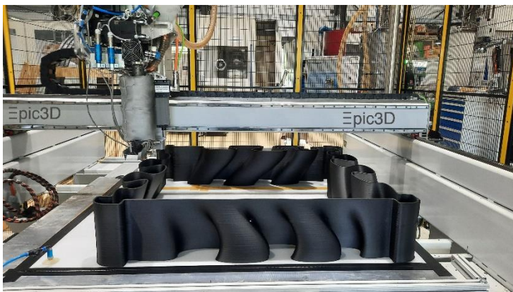
Abb. 1 Der neue Portaldrucker Epic3D erlaubt die additive Herstellung besonders großer Bauteile. © Fraunhofer IWU
