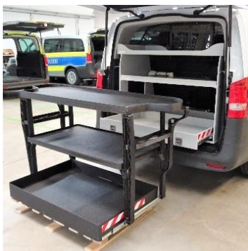
Abb. 5 Das Fraunhofer IWU und die MOSOLF Special Vehicles GmbH haben ein 3D-gedrucktes Heckregal entwickelt, das am Beispiel des Mercedes Vito im Vergleich zur bisherigen Nachrüstlösung einschließlich der Beschläge 26,5 Kilogramm einspart. Dabei bleibt die Nutzlast des Regalsystems vollständig erhalten. Das im SEAM-Verfahren gedruckte Regal schmiegt sich vollständig an die Fahrzeughaut, erfordert keine zusätzlichen Versteifungen oder Befestigungen und nutzt so den Bauraum im Heckbereich bestmöglich aus. Die beiden Partner arbeiten an weiteren Interieurbauten für Spezialfahrzeuge, insbesondere an Innentrennwandsystemen. © MOSOLF Special Vehicles GmbH
