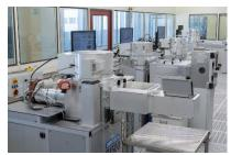
Im Rahmen der APECS-Pilotlinie wird u. a. der Bereich Trockenätztechnik im Reinraum des Fraunhofer IAF für 6''-Wafer erweitert. © Fraunhofer IAF
