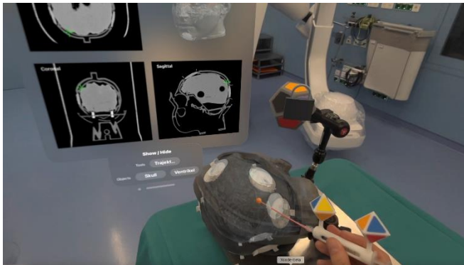
Abb. 2 Das am Fraunhofer IWU in Zittau entwickelte und 3D-gedruckte Handstück für Operationsinstrumente enthält Marker-Geometrien, die von der Datenbrille erkannt werden. © Fraunhofer IWU
