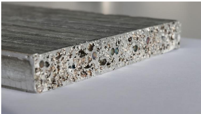
Abb. 1 Der Werkstoffverbund HoverLIGHT hat einen Kern aus Aluminium-Schaum und darin eingeschäumten Hohlkugeln (im Schnittbild als runde Öffnungen sichtbar). Die kombinierten Dämpfungseffekte von Schaum und partikelgefüllten Hohlkugeln sind mit denen von Magnesium vergleichbar. © Fraunhofer IWU
