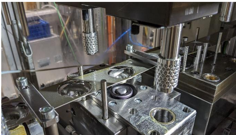
Abb. 3 Serienfähig: Tiefziehen mit Ultraschall-Aktorik unter der Matrize. © Fraunhofer IWU
