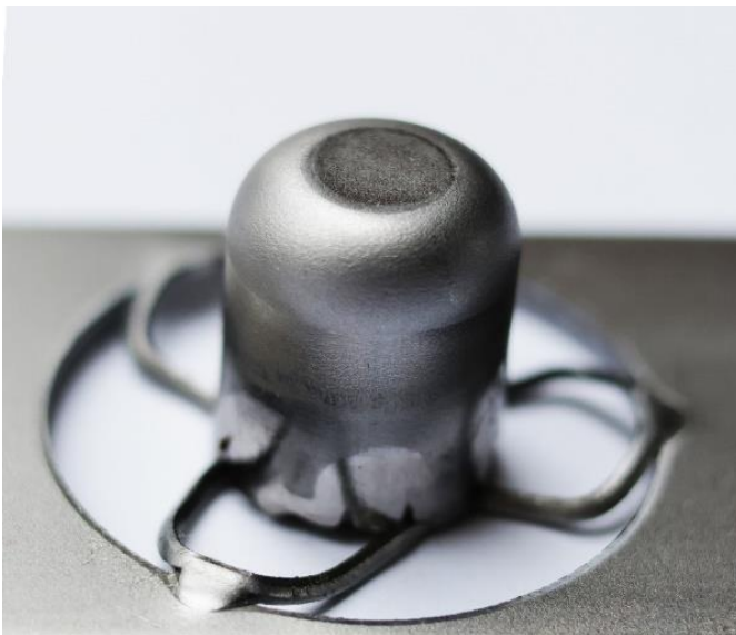
Abb. 1 Das Ultraschall-Tiefziehen macht den Unterschied: mit Ziehverhältnis 2,3 und Schwingungsunterstützung tiefgezogener, etwa 5 cm langer Napf. © Fraunhofer IWU
