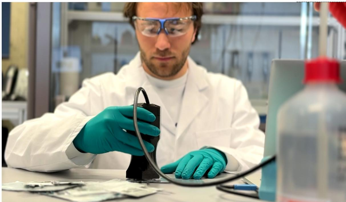
Einfaches Auslesen der Informationen der mit Fluoreszenzmarkern gekennzeichnete Batteriezellen © K. Selsam, Fraunhofer ISC / IDcycLIB
