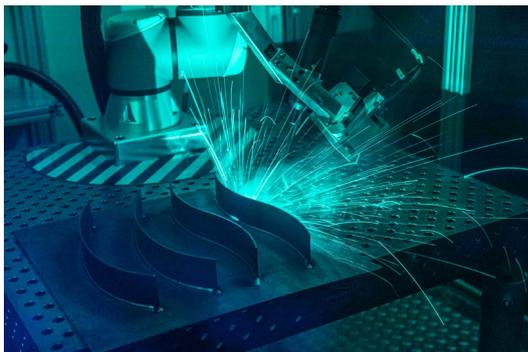
**Bei einer Besichtigungstour am Fraunhofer IPA erleben die Gäste kognitive Roboteranwendungen wie beispielsweise das Schweißen für kleine Losgrößen.**
