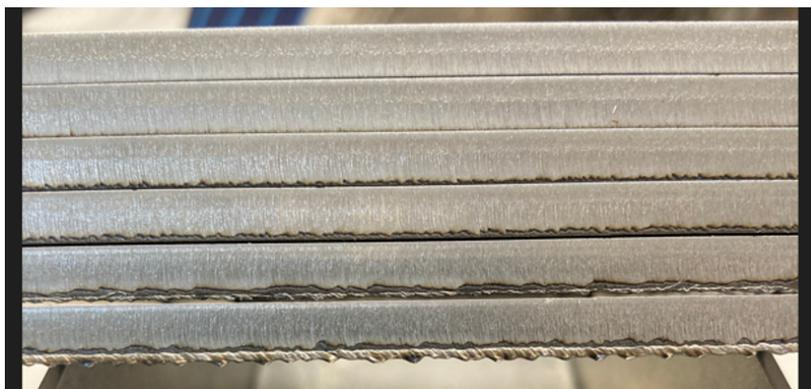
**Die Qualität verbessert sich in jedem Schritt. Mit den Standardparametern (unten) entsteht ein sehr großer Grat, dieser reduziert sich schrittweise und erreicht nach fünf Iterationen eine ideale Qualität.**
