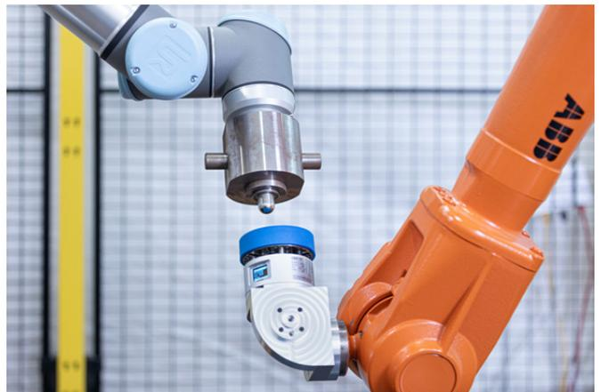
**Auf dem automatischen Kollisionsprüfstand werden Cobots einmalig vermessen und so ein Kollisionsmodell erzeugt, das bei der Sicherheitsauslegung genutzt werden kann.**
