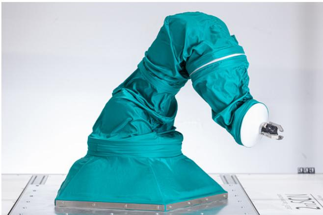
**2ndSCIN® ist eine Schutzhülle für Roboter und andere Automatisierungskomponenten, die in einem Reinraum zu Einsatz kommen sollen.** Quelle: Fraunhofer IPA/Foto: Rainer Bez
