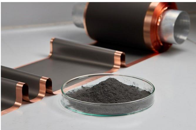
**Abb. 2 Mit der neuen Trockentransfertechnologie DRYtraec® werden Elektroden von Energiespeicherezellen mit einem trockenen Film statt mit flüssigen Chemikalien beschichtet.**
