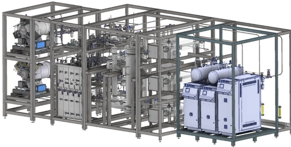
a) Kompressoren b) Prozesseinheit d) Rektoreinheit c) Wärmemanagement
