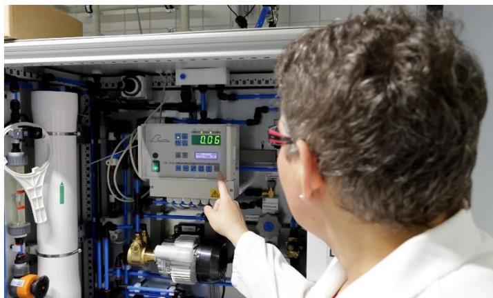
**Abb. 2 Kompakt und doch komplett: Die Umkehrosmoseanlage, die Reinstwasser für die Befeuchtung des Brennstoffzellensystems während der Prüfung zur Verfügung stellt (Foto: Dr. Carmen Meuser).**
