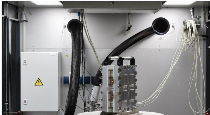
**Abb. 1 »Unverbaut«, großzügig dimensioniert und daher vielfältig einsetzbar: Der Prüfstand am IWU wird vorrangig zur Überprüfung der Qualität und Funktionalität von Brennstoffzellen während der Produktion zum Einsatz kommen. Die Leistung des Prüfstands beträgt 80 kW, mit Quelle/Senke 800A, 500V DC.**
