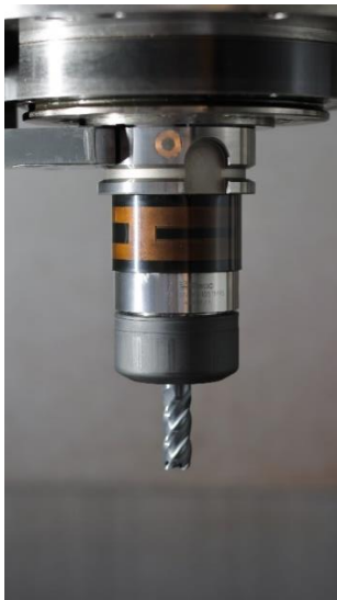
Abb. 2 Die neue Generation smartTOOL harmonisiert mit nahezu jeder Spannfuttergeometrie. © Fraunhofer IWU
