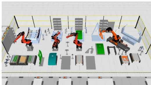
Abb. 2 Screenshot (siehe Video online): automatisierte Montage-/ Fügeprozesse bzw. Logistik von Flugzeugtüren. © Fraunhofer IWU
