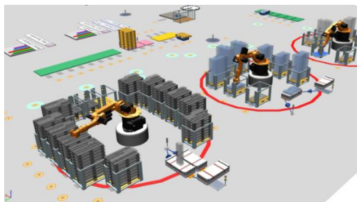
Abb. 3 AutoLog: Skalierungsmöglichkeiten ergeben sich durch den einfachen Zellenaufbau. © Fraunhofer IWU
