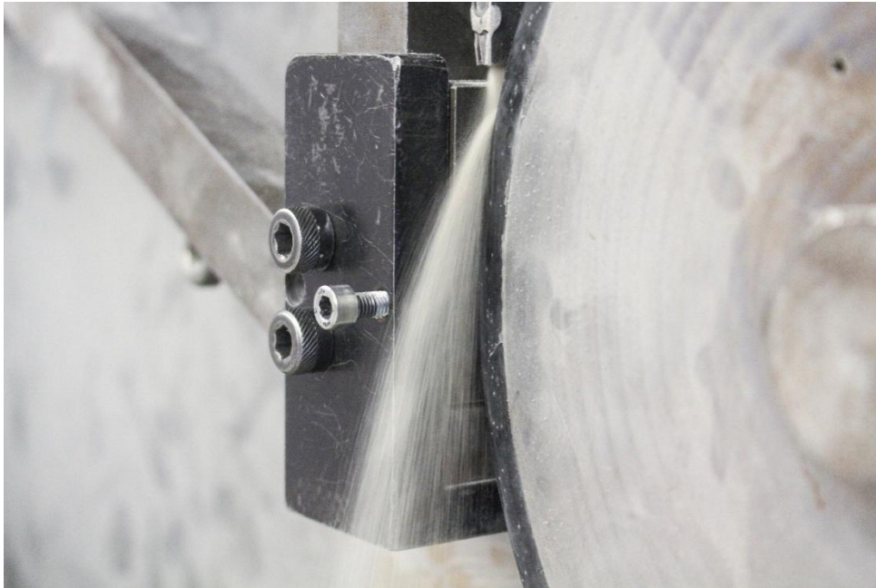
Bildunterschrift: Proben des neuen Chrom-Nickel-Stahls werden in den Laboren der Hochschule Osnabrück verschiedenen Tests unterzogen und – wie hier – auf ihren Abrieb untersucht (Foto: Hochschule Osnabrück).
