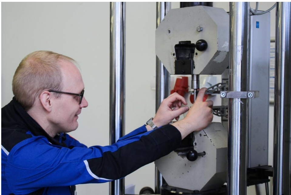
Bildunterschrift: Die Tests zeigen: Auch mit mehr Recyclingmaterial bleibt der Stahl ebenso fest (Foto: Hochschule Osnabrück).
