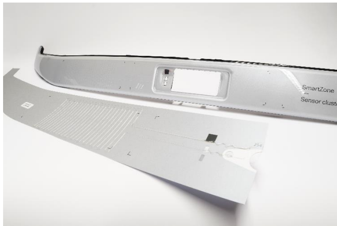
Abb. 2 Hochflexible, dehnbare und 3D-formbare Platinen – WEAM-Aufdruck einer Kupferleitung mit 0,1 mm Durchmesser auf einer 0,1 mm dünnen thermoplastischen Polyurethan-Folie © Fraunhofer IWU
