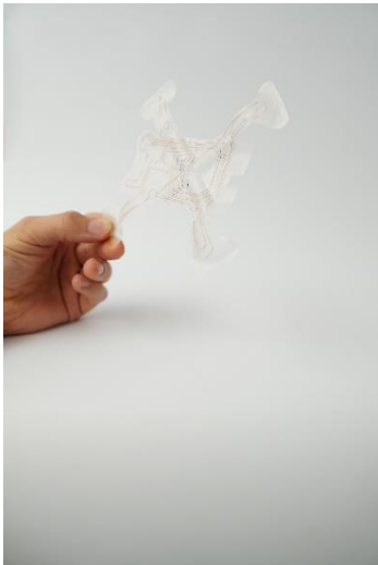
Abb. 4 Beispiel Drohne: Bauteilgehäuse mit integrierten elektrischen Funktionen © Fraunhofer IWU
