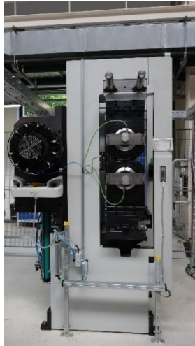
Abb. 2 Kompakt und leistungsfähig: die flexROLLmax (links) kann Bleche bis 0,5 mm Stärke prägen (Elektrolyseure), die BPPflexROLL ist für besonders geringe Blechstärken (Brennstoffzellen) bestens geeignet.
