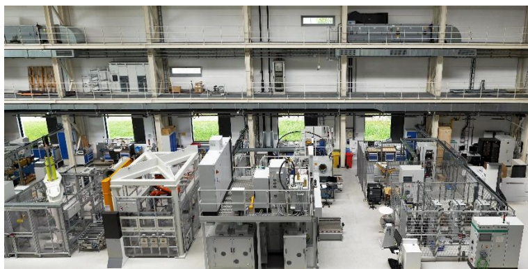
Abb. 1 Blick in die Referenzfabrik.H2. Rechts vorn die BPPflexROLL, dahinter die flexROLLmax. In der Mitte die beiden Anlagen für das Elektronenstrahlschweißen; links die neue Stackinganlage. © Fraunhofer IWU
