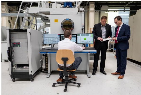
Abb. 3 Die Referenzfabrik.H2 verfügt über zwei Elektronenstrahlanlagen. Das Elektronenstrahlschweißen erlaubt die gleichzeitige Bearbeitung mehrerer Fügestellen.
