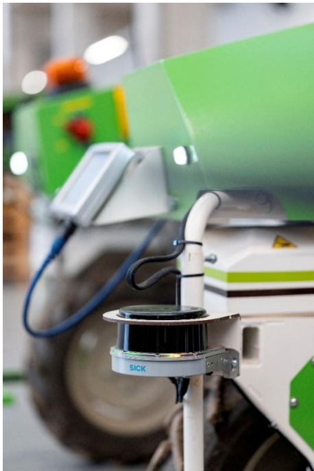
Bildunterschrift: Moderne Sensorik unterstützt autonome Fahrsysteme bei der zuverlässigen Wahrnehmung ihrer Umgebung – im Straßenverkehr oder wie hier in der Landtechnik (Foto: Hochschule Osnabrück).
