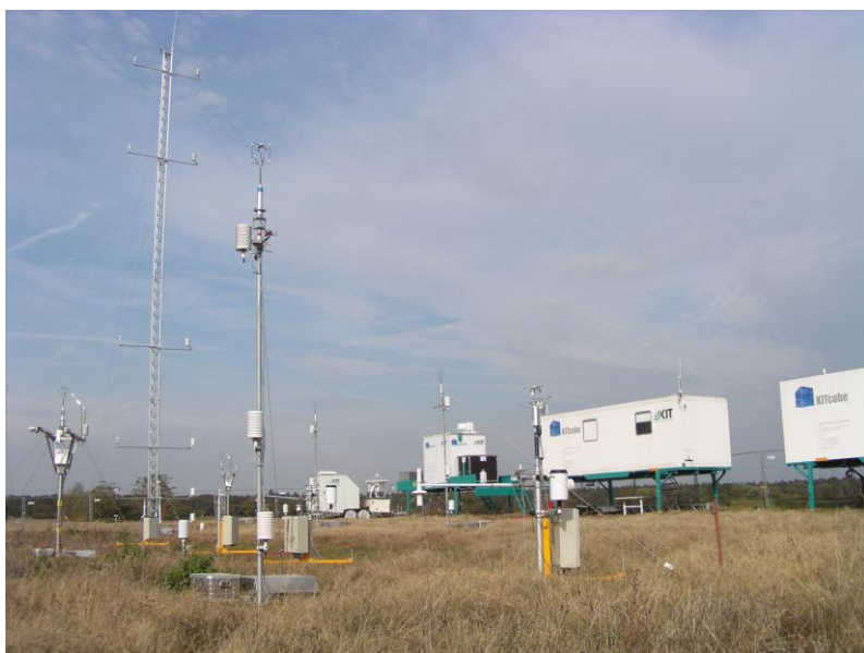
KITcube, ein mobiles High-Tech-Messfeld zur detaillierten Untersuchung von atmosphärischen Vorgängen. (Foto: KIT)
