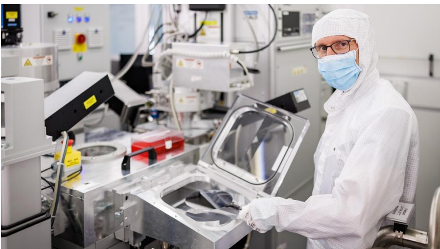
Reinraummitarbeiter am Fraunhofer THM beim Einlegen eines Wafers in die Transferkammer eines Abscheide- / Ätzclusters für die Strukturierung mittels Atomlagenätzung. © Daniel Karmann / Fraunhofer IISB
