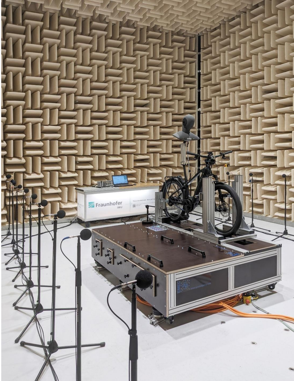
Abb. 1 Der von der EMEC Prototyping GmbH entwickelte und gemeinsam mit dem Fraunhofer IWU validierte Akustikprüfstand bei Tests mit einem hochwertigen E-Bike am Fraunhofer IWU Dresden. © Fraunhofer IWU
