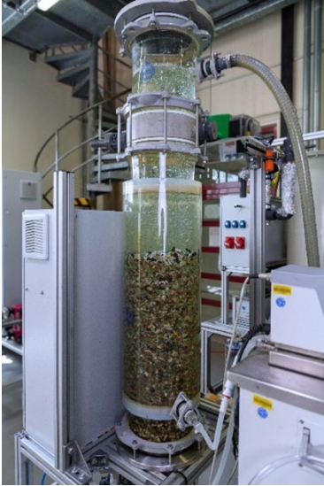
Abb. 2 Das Fraunhofer IGB hat einen Festbett-Umlaufreaktor zur Rückgewinnung von Wertstoffen wie Seltenen Erden aus Elektroschrott entwickelt.
