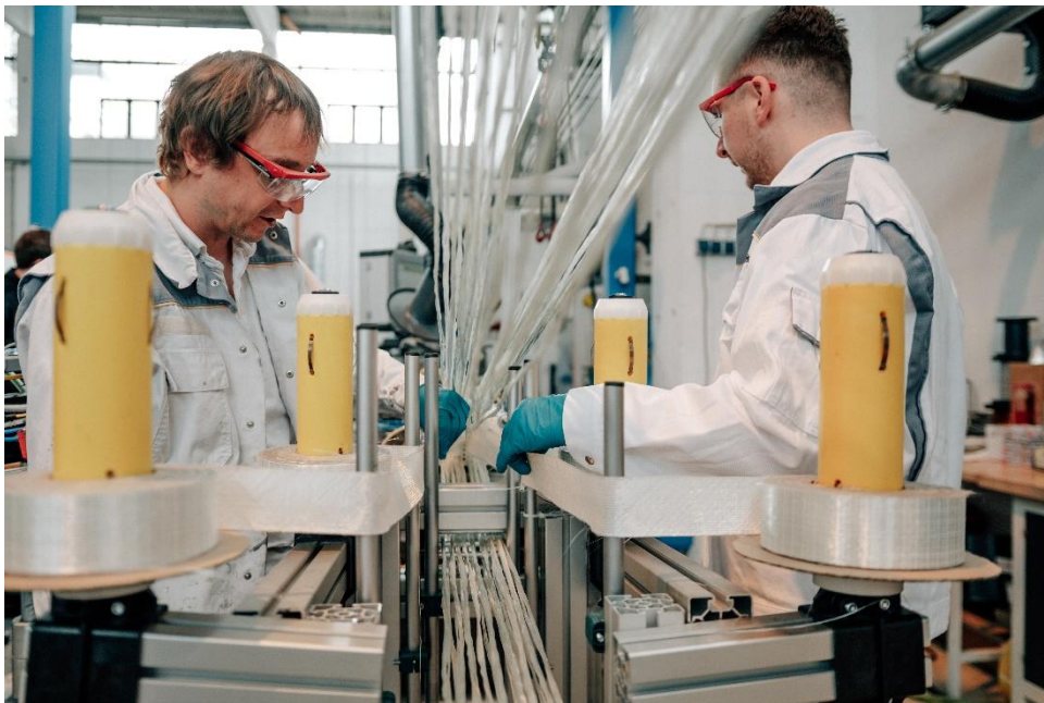
Abb. 1 Pultrusion: lange, leichte und zugleich hochfeste Faserverbundprofile. © Fraunhofer IWU
