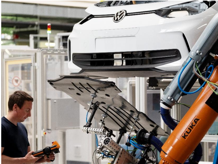
Abb. 1 Versuche für automatisiertes Handling mit anschließender Montage einer Unterbodenverkleidung am Fraunhofer IWU (mit Projektleiter M.Eng. Marcel Lorenz) © Fraunhofer IWU
