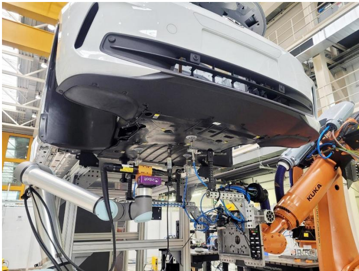
Abb. 2 Automatisiertes Verschrauben nach erfolgreichem Handling © Fraunhofer IWU
