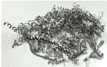
Abb.2 Aluminiumlegierungsspäne als Ausgangsmaterial für hochwertigen Leichtbau. © Fraunhofer IWU
